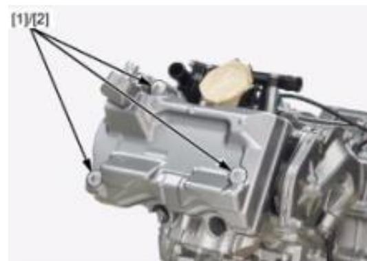
Снять крышку головки блока цилиндров [1].
