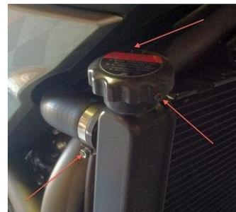
Выкрутить болты [1], снять нижнее крепление радиатора [2].
