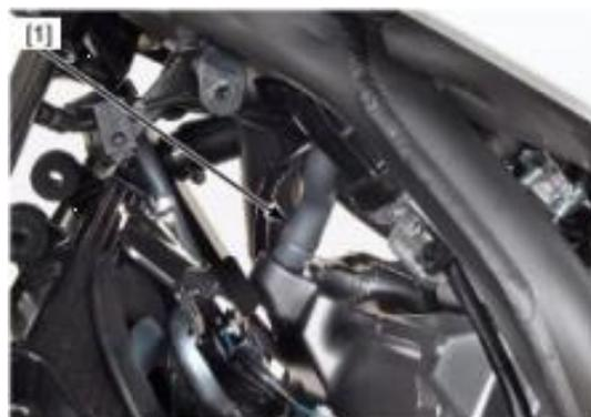
Выкрутить и вынуть болты крышки головки блока цилиндров [1].
