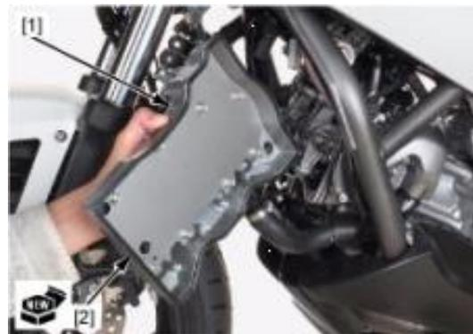
Снять крышки коленчатого вала [1] и [2], не потерять уплотнительные кольца [3].
