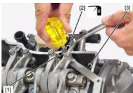
Чтобы отрегулировать зазор удерживайте регулировочный болт отверткой и ослабьте контргайку.
