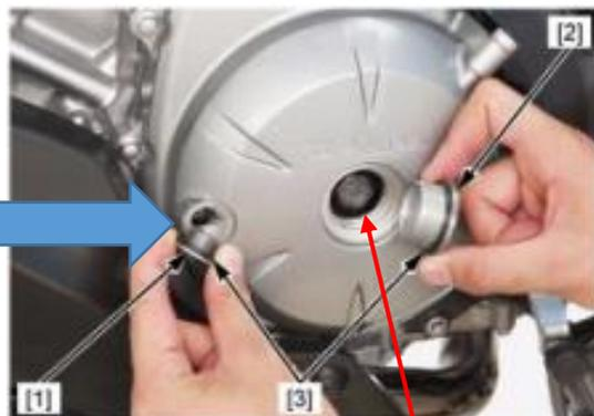
Снять крышку распределительного вала [1], не потерять уплотнительное кольцо [2].
