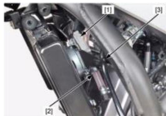
Аккуратно отодвинуть радиатор не испортив оребрение, отсоединить трубку вентиляции картерных газов [1].
